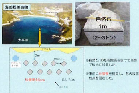
図1 単体礁に用いた石材と配置
