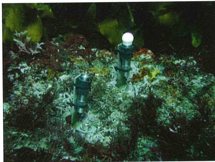
写真4 谷津地先における水中光量子計（右）と水温計（左）の設置状況（谷津では岩盤上に、坂井平田ではN型ブロック上に設置した）
